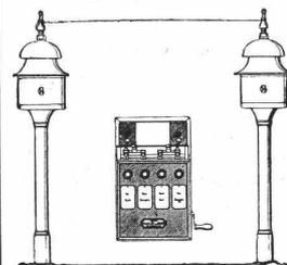
Spezielle Telephone für Starkstromanlagen
