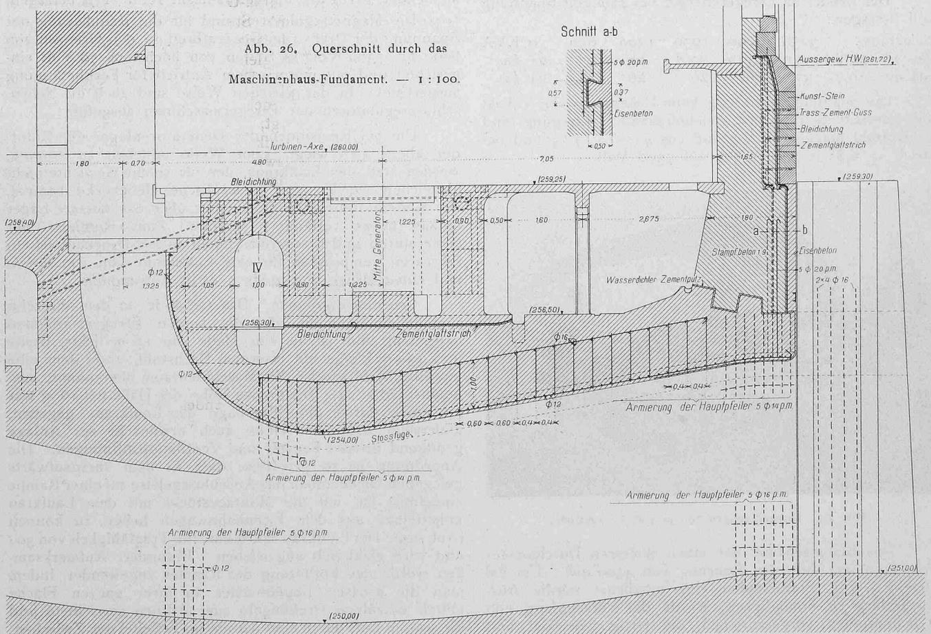
Abb. 26. Querschnitt durch das Maschinenhaus-Fundament. — 1 : 100.
