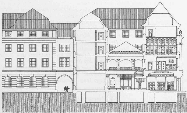
Längsschnitt durch das Gebäude der Schw. Nationalbank. 1 : 600.
