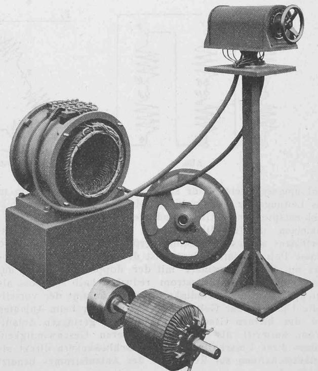
Abb. 9. Vierstufen-A-Motor, System Oerlikon. — Demontiert.
