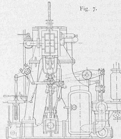
Dampf-Schiffsmaschine 1 : 50.
