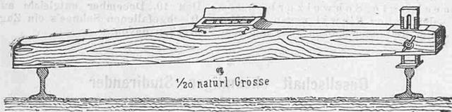
Die Eisenbahnwasserwage ist in einem hölzernen Lineal von 1740 m/m gefasst, dasselbe ist an den beiden Auflageflächen mit eisernen Schienen versehen, die verstellbare Zunge ist in Doppel-Millimètres und Linien eingetheilt und kann 150 m/m ausgezogen werden. Eine Schraube mit bequemer, starker Flügelmutter (aus Rothguss) erlaubt die Feststellung der Zunge.
