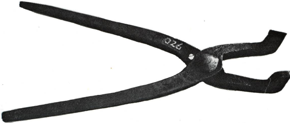
Zange zum Halten der Nagelhämmer beim Schmieden und Abrichten derselben. Länge: 30 cm
