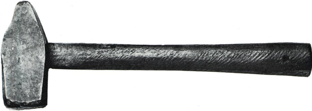
Spannhammer. Länge: 38 cm
