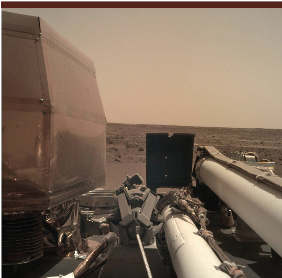
Abbildung 3: Die Instrument Deployment Camera (IDC), die sich am Roboterarm des InSight-Landers der NASA befindet, schoss dieses Bild von der Marsoberfläche am 26. November 2018, am selben Tag, an dem das Raumfahrzeug auf dem Roten Planeten landete. Die transparente Staubschutzhülle der Kamera ist noch vorhanden, um zu verhindern, dass sich bei der Landung hochgeschleuderte Partikel auf dem Objektiv der Kamera festsetzen. Die Aufnahme wurde von InSight via die Raumsonde Odyssey der NASA zur Erde übertragen, die derzeit den Mars umkreist.
