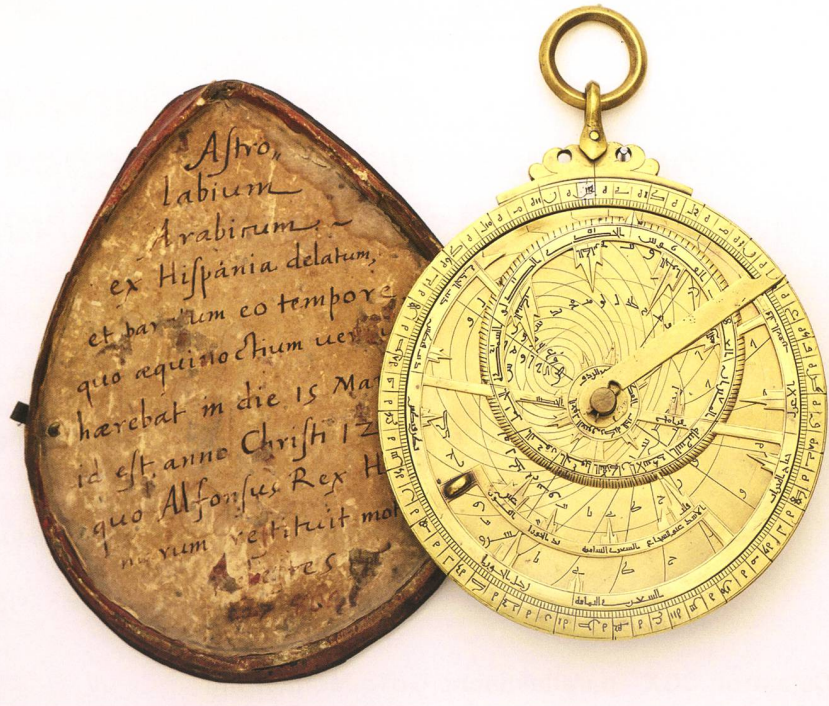
Abbildung 4: Astrolabium aus dem 9. Jahrhundert. Astrolabien dienten der Zeitbestimmung und zur Ermittlung der Position von Sternen, u.a. für astrologische Vorhersagen.
