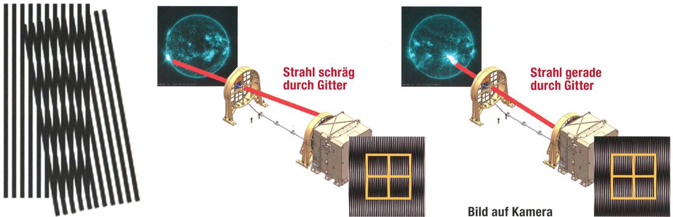
Abbildung 3: Der Moiréeffekt. Durch Überlappen von zwei zueinander geneigten Gittern entsteht ein Muster. Rechts: Röntgenstrahlen von der Sonne fallen je nach ihrem Ursprung mit verschiedenen Winkeln auf die Gitter, was zu verschiedenen Mustern auf der Kamera führt. Die orangenen Quadrate symbolisieren 4 Beispielpixel auf der Kamera. In den zwei Beispielen sieht man, dass die Pixel je nach Einfallswinkel verschieden hell sind und somit kann man zurückrechnen, wo die Röntgenstrahlen herkamen.
