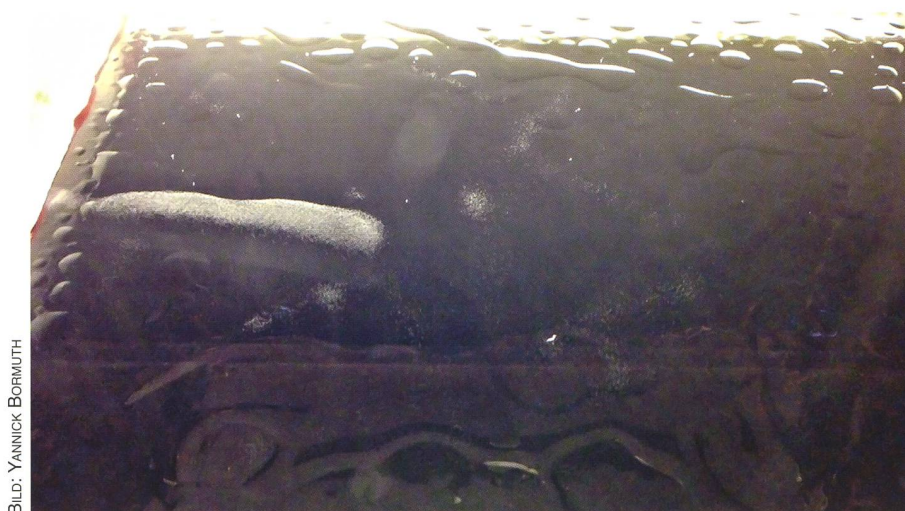
Abbildung 2: Typische Spur eines Alpha-Teilchens (links im Bild). Da Alpha-Teilchen um ein Vielfaches schwerer sind als Beta-Teilchen oder Myonen, erzeugen sie eine viel dickere Spur.
