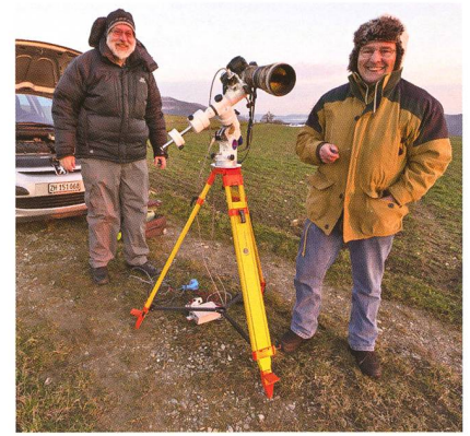
Abbildung 6: Für Bild 5 verwendete Fotoausrüstung: Canon EOS 5D Mark III mit Canon Objektiv 50 mm f4 auf Vixen GP D2. Als Stromquelle dient die Autobatterie. Eine steife Bise und Temperaturen unter dem Gefrierpunkt machen «polare» Kleidung erforderlich. (Bild: Jürg Alean)
