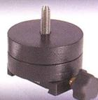
Optionale Ausgleichsgewichte ermöglichen ein Austarieren des Tubus bei aufgesetztem Zusatzgerät, wenn unten am Tubus eine zweite Schiene angeschraubt wird. Der Gegengewichtssatz besteht aus einer Gewichtsaufnahme, die an die Schiene geklemmt werden kann, sowie zwei Gegengewichten zu je ca. 1,5kg.
