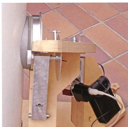
Abbildung 11: Das Deklinationsgetriebe  $i = 1:4$ .
