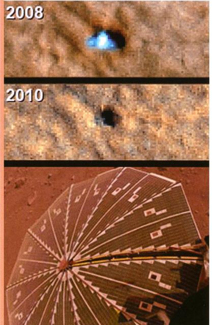
Während mehr als 200 Flüge von Orbiter Mars-Odyssey über der Landungsstelle horchte die Sonde nach Funksignalen von Phönix. Aber jeder Horchversuch endete ergebnislos. Nach den jüngsten vom Orbiter geschossenen Aufnahmen fielen die Solarpanele von Phönix durch die durch die Vereisung durch Kohlendioxid verursachte Verformung aus. «Wir haben keine Hoffnungen mehr», sagte der Vertreter der NASA, PETER SMITH. (aba)
