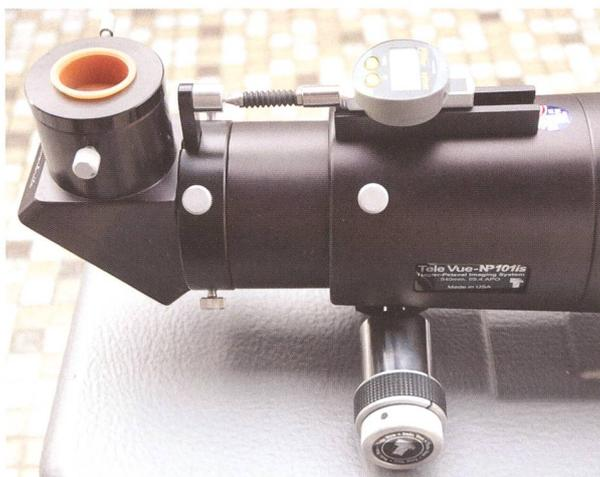
Gros plan sur le comparateur Sylvac pour la mesure de l'amplitude du porte oculaire et sur le mécanisme de mise au point démultipliée Focusmate. (Photo: Robert Rivoir)
