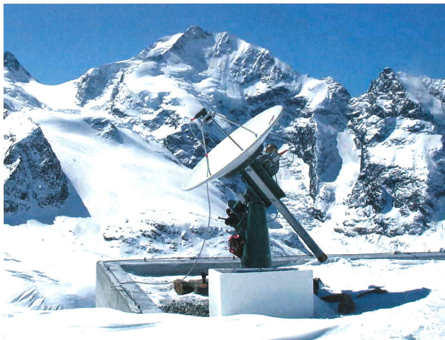
Abb. 1: Das 1m Radioteleskop für Zentimeterwellen mit parallaktischer Montierung auf der ARA des Hotel Diavolezza, im Hintergrund der noch tief verschneite Piz Bernina und der Morteratschgletscher. Im Vordergrund eine Obstkiste aus Styropor zur Aufnahme eines 12V-Autoakkus sowie eines Sendeempfängers zur drahtlosen Steuerung respektive Überwachung des Teleskops.
