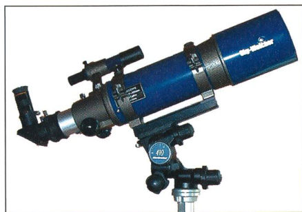
Fig.1: Antares R102/500 auf Manfrotto Junior Getriebeneigekopf 410 und Stativ.
