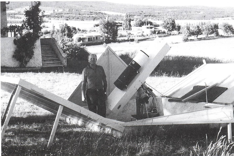
Fig. 1. Die Klapphütte mit dem 21-cm Newton und der 20/22/30-cm Schmidtkamera
