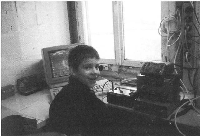
Bild 3: Der 'Junior-Autor' bei der Überwachung der Empfangsanlage bestehend aus Kommunikationsempfänger, ZF-Eichleitung, Quadratischer Demodulator und Verstärker sowie Analog-Multimeter. Nicht sichtbar der PC zur Messdatenerfassung via A/D-Wandler. Im Hintergrund der Steuer-PC zur automatischen Nachführung des Spiegels in Azimut und Elevation.
