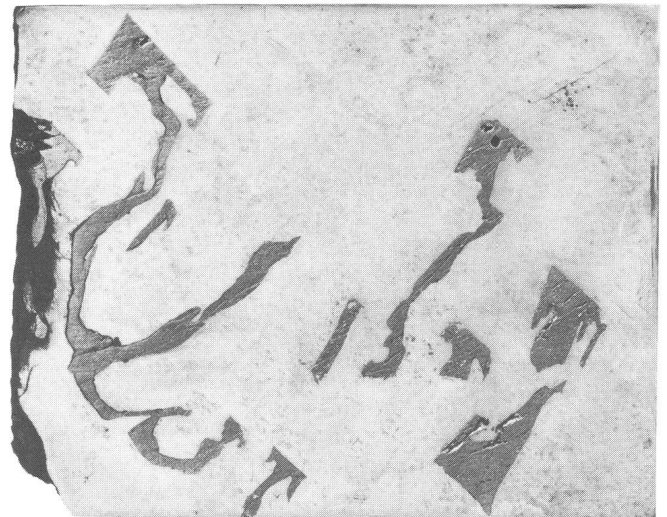
Tombigbee River, anormaler Hexaedrit (IRANOM): Grosse hieroglyphenartige Schreibersit-Kristalle mit kleinen rundlichen Troilit-Einschlüssen sind eingebettet in relativ nickelarmes Eisen (5,1 Prozent Ni) mit teilweise rekristallisierten Zonen (hellgraue, fleckige Bereiche). Feine Neumannsche Linien, charakteristisch für diese Meteoritenart, sind auf der Abbildung nicht erkennbar. Vergrößerung: abgebildeter Bereich \times 1,2
