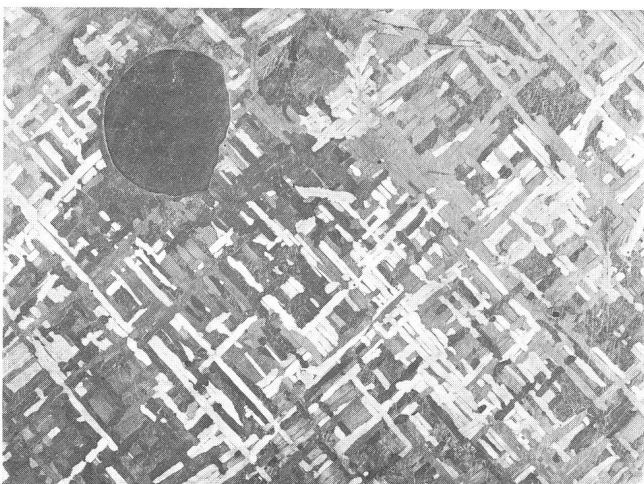
Cape York, Eisenmeteorit (Oktaedrit III A-Om): Die Probe stammt von einem 20,1 Tonnen schweren Meteoriten, der vom dänischen Meteoritenspezialisten VAGN. F. BUCHWALD 1963 als Teil eines Schauers in Melville Bay, Nordgrönland, gefunden wurde. Sehr schön sind die im Text erwähnten Widmannstättenschen Figuren zu erkennen, die sich hier im Winkel von etwa 90 Grad schneiden. Der runde Einschluss oben links ist Troilit (Schwefeleisen), er misst im Durchmesser 3 cm. (Foto: V.F. BUCHWALD)
