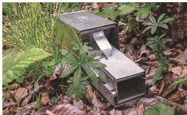
Abbildung 3: Die Lebendfalle vom Typ Longworth ist geeignet, um eine ganze Breite von verschiedenen Kleinsäugerarten nachzuweisen. Bild: Heinz Borgmann
