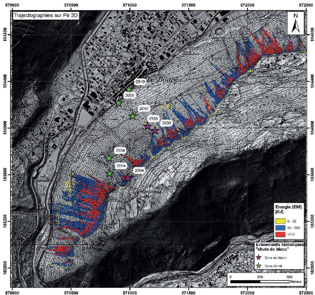
Figure 3.—Résultats des simulations trajectographiques sur PiR3D.
