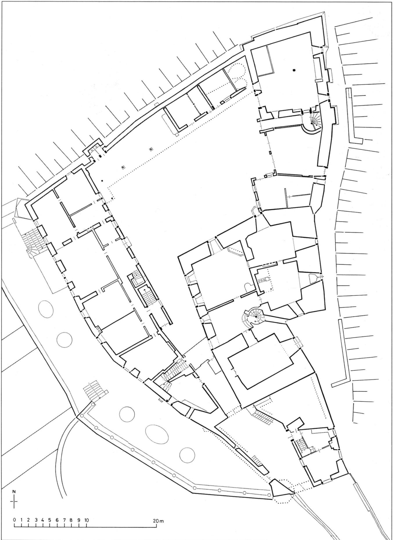
3: Worb, Schloss, Gesamtgrundriss auf Höhe des Zugangsgeschosses von Bergfried und Palas beziehungsweise auf Erdgeschosshöhe von Ritterhaus und Westtrakt, Massstab 1:300.
