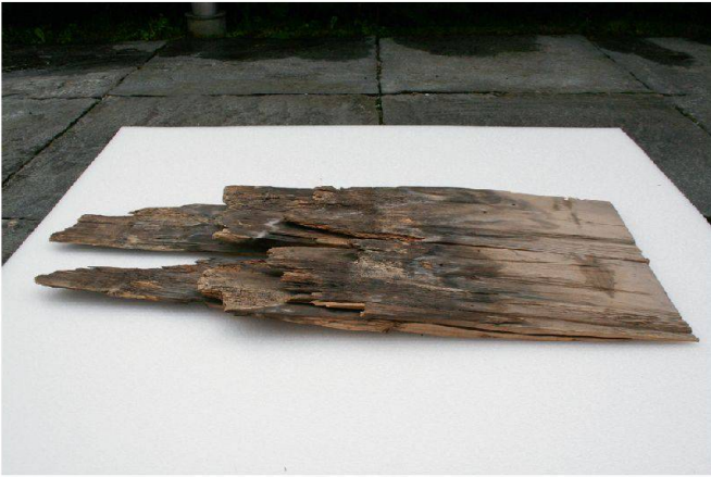
Abb. 16: Im Zuge der Renovierung der Muotathaler Pfarrkirche St. Sigismund und Walpurga im Jahr 2003 wurden Dachschindeln aus Fichtenholz (ca. 55cm x 20cm), sogenannte Spaltschindeln, geborgen, die noch aus der Bauzeit um 1780 stammen. Die Lebensdauer von Dachschindeln wird je nach klimatischen Bedingungen auf über 50 Jahre geschätzt. Eine Dacherneuerung war sehr aufwändig, daher mussten Schindeldächer bei vielen Alphütten im 20. Jahrhundert Blechdächern weichen.
