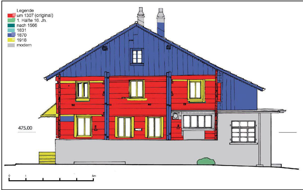
Abb. 10: Westfassade, die ursprünglichen Bauteile sind rot angelegt.
