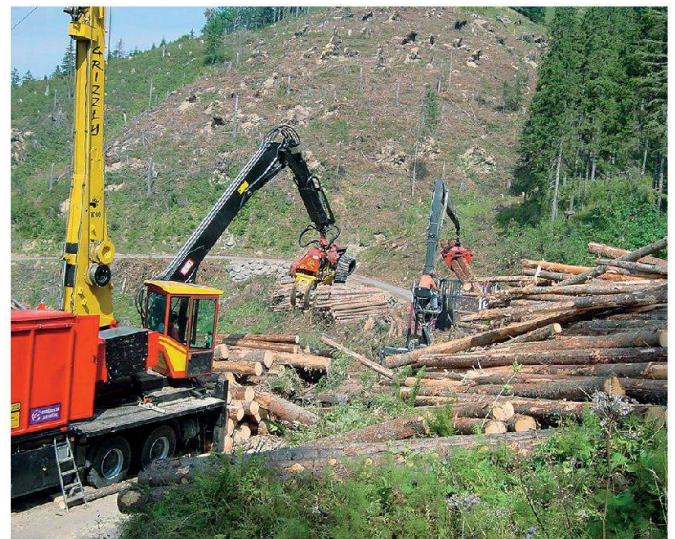
Abb. 27: Moderne Holzernntemaschine (Gebirgsarvester).
