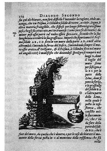
Galileo Galilei, dessin d'une poutre avec une extrémité libre et l'autre encastree dans un mur (G. Galilei, Discorsi e dimostrazioni matematiche intorno à due nuove scienze attenenti alla Meccanica e i movimenti locali, Leida, 1638, p. 114).
