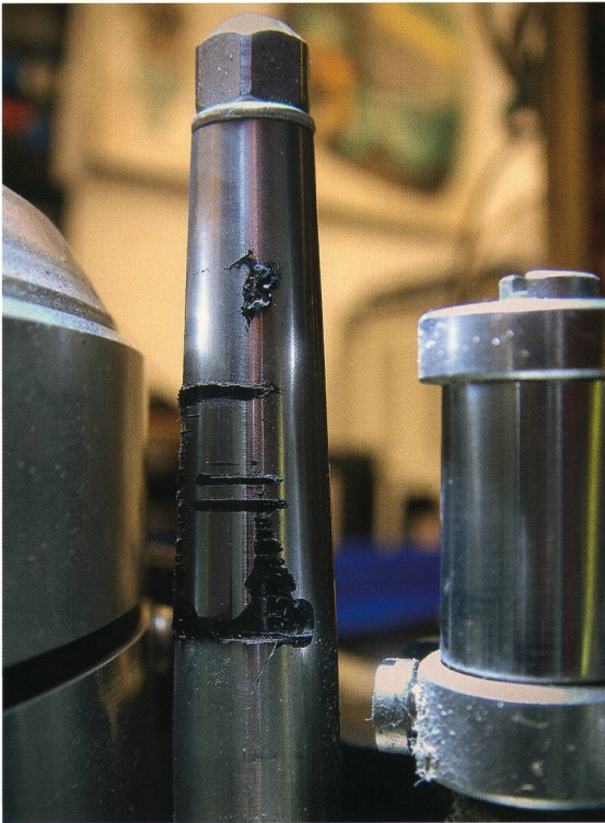
ABB. 12 Verschmutzter Umlenkbolzen beim Trommeleinlauf (Sony AV-3670), Foto: Johannes Gfeller
