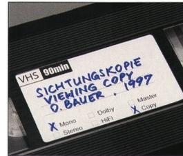
In welcher **Farbfernsehnorm** ist die Kassette aufgezeichnet (z. B. **PAL**, **NTSC** oder **SECAM**, manchmal auch bezeichnet als 625/50, 525/60)? Die Abspiel- und Sichtgeräte müssen mit der Farbfernsehnorm der Kassette übereinstimmen, sonst treten Bild- und Tonstörungen auf (vgl. >Inkompatibilität der Farbfernsehnormen [PAL – NTSC – SECAM]).
