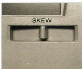
**U-matic**-Abspielgeräte verfügen zur Regelung des **Bandzuges** über einen **Skew-Regler**. Stellen Sie diesen vor der Sichtung in die mittlere Position (vgl. *>Skew-Fehler*).
