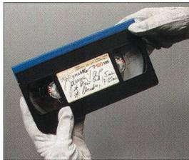
Berühren Sie nie das **Magnetband** mit blossen Händen, da bereits kleinste Fingerabdrücke und Verunreinigungen zu **Dropouts** führen. Es ist empfehlenswert, sich vor dem Sichten die Hände zu waschen oder Handschuhe zu tragen. Sie schonen damit auch das Kassettengehäuse und die Etiketten, die oft eigenhändig vom Künstler beschriftet sind.
