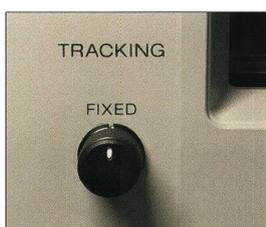
Wenn Ihr Abspielgerät über einen **Tracking-Regler** verfügt, stellen Sie ihn vor der Sichtung in die mittlere Position. Bei modernen Abspielgeräten können sich die Tracking-Einstellungen auch per Fernbedienung, bzw. über das Menü regeln lassen (vgl. *>Tracking-Fehler*).
