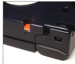
Vergewissern Sie sich vor dem Einlegen der Kassette, dass sich die Etiketten nicht lösen oder über die bewegliche Schliessklappe der Kassette geklebt sind. Auch evtl. vorhandene Post-it-Kleber müssen entfernt werden, da sie sich im Gerät lösen könnten.
