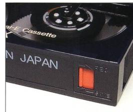
Alle analogen und digitalen Kassetten der **Betacam**-Familie, sowie MPEG IMX, HDCAM und HDCAM SR: Auf der Unterseite der Kassette befindet sich ein roter Riegel, der hinuntergedrückt sein muss.
