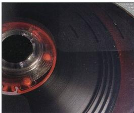
Zeigt der **Bandwickel** Stufen, bzw. wellige Bandpakete? Wenn ja, spulen Sie das Band komplett vor und wieder zurück. Wenn das Band beim Spulen stockt oder quietscht, unterbrechen Sie den Spulvorgang sofort. Geben Sie es beim Verdacht auf *>Bandkleben und -quietschen* ungesichtet an einen Videorestaurator.
