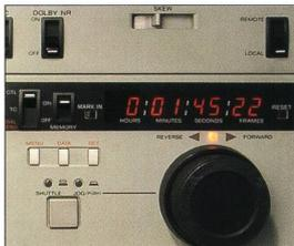
Verfügt das Band über einen **Time Code**, erscheint dieser bei der Wiedergabe automatisch im Display des Gerätes (Schalter in TC-Stellung). Ist kein Time Code mit aufgezeichnet, stellen Sie am Anfang oder an gewünschter Stelle des Bandes den Zählerstand am Gerät manuell auf 00:00:00 (Schalter in CTL-Stellung und Reset-Schalter betätigen).
