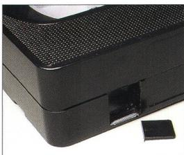
**VCR, Betamax, VHS, S-VHS, VHS-C und S-VHS-C:** Auf der Seite oder Unterseite der Kassette befindet sich eine Kunststoffzunge, die herausgebrochen sein muss.
