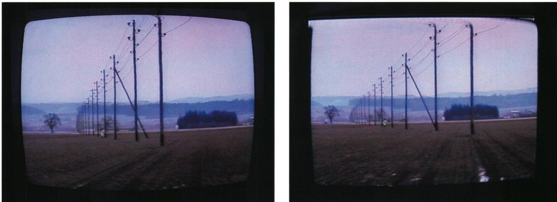
Links: Normalerweise ist das **Bildraster** vom Gehäuse des Monitors oder TV-Empfängers beschnitten. Rechts: Im aktivierten **Underscan**-Modus hingegen werden einige Bildstörungen erst richtig sichtbar, wie z. B. ein Bildverzug bei >Dehnung oder Schrumpfung des Bandes in Längsrichtung.
