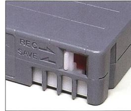
**Video8, Hi8, Digital8:** Auf der Seite der Kassette befindet sich ein Schieber, der geschlossen sein muss.
