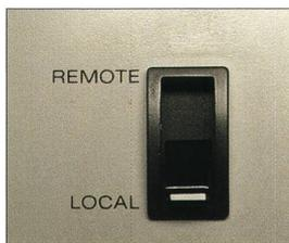
Professionelle Abspielgeräte ab **U-matic** verfügen über einen sog. Remote-Schalter, mit dem geregelt werden kann, ob das Gerät direkt («Local») oder mittels einer externen Steuerung («Remote») bedient wird. Überprüfen Sie die korrekte Stellung des Schalters.
