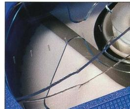
Sind einzelne Lagen aus dem **Bandwickel** gezogen, bzw. ist das Band an der Schliessklappe herausgezogen und eingeklemmt? Dann legen Sie das Band nicht in das Abspielgerät ein, da sonst die Gefahr eines Bandsalates besteht. Geben Sie es ungesichtet an einen Videorestaurator.
