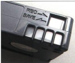
Damit eine Videoaufzeichnung bei der Wiedergabe im Rekorder nicht versehentlich gelöscht oder überschrieben wird, verfügen alle Kassetten über eine mechanische Sicherung. Dieser Löschschutz sollte unbedingt aktiviert sein. Wenn dies nicht der Fall ist, holen Sie dies nach. Je nach **Videoformat** gibt es verschiedene Systeme des Löschschatzes.
