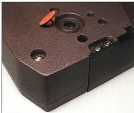
**U-matic:** Auf der Unterseite der Kassette befindet sich ein roter Stöpsel, der entfernt sein muss.
