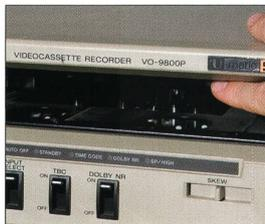
Das Gerät sollte sauber und intakt sein. Werfen Sie einen Blick ins Kassettenfach: Ist das Fach leer, ist es staubfrei? Loser Staub kann mittels Druckluft(-Spray) und kräftigem Staubsauger entfernt werden. Fassen Sie niemals an die **Kopftrommel** und die **bandführende Teile**. Lassen Sie hartnäckigere Verschmutzungen vom Fachmann entfernen und das Gerät in regelmässigen Abständen warten.
