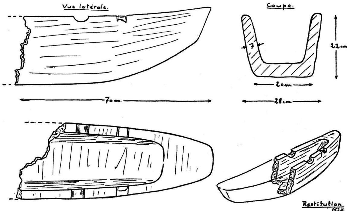
Fig. 51. Balancier d'une pirogue de La Tènevière, Concise
