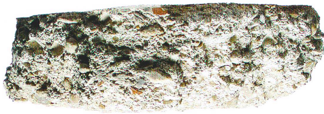
Abb. 5: Augst (BL), Insula 3 (Grabung 1917.51), bemalter Wandverputz. Kat. 1: Querschliff durch den Putz von Inv. 1917.2274i. Zu unterscheiden sind die Putzschichten 2 und 3 sowie der Intonaco. Für die an diesem Stück nicht erhaltene Putzschicht 1 siehe Abb. 6. M. 1:1.
