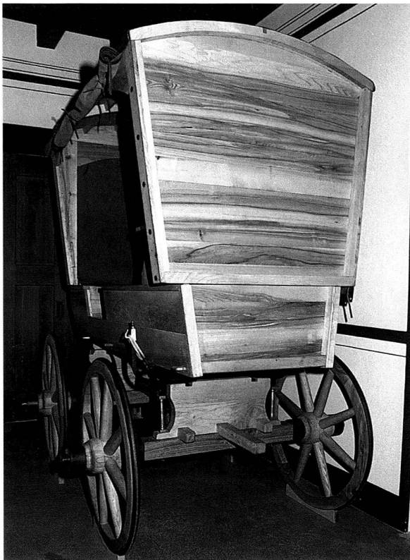
Abb. 22: Der Römerwagen steht normalerweise im Eingangsraum des Augster Römerhauses, direkt hinter dem Portal. Er ist 2,29 m lang (ohne Deichsel), hat einen Radabstand von 1,37 m (Raddurchmesser: 1,01 m) und ist mit dem Wagenkasten 2,71 m hoch. Verschiedene Balkenköpfe sowie die Rückseite des Wagenkastens sollen noch mit Bronzezierteilen nach Originalfunden aus Augusta Raurica ergänzt werden.
