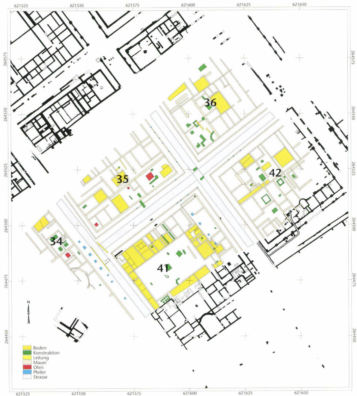
Abb. 10: Augst, insulae 34–36 und 40–42. Zweidimensionale Interpretation aller Prospektionsmethoden. Man vergleiche, wie gut die Resultate des Bodenradars mit den Grabungsergebnissen im Südwesten (schwarz ausgezogene Strukturen) übereinstimmen. M. 1:1000.
