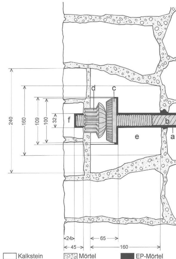
Abb. 37 Augst, Theatersanierung (Grabung 1992.55). Konstruktions-Schema der Maueranker. a) Bohrloch  $\varnothing$  32 mm; b) Glasfaserstab  $\varnothing$  22 mm mit endständigem Kunststoffgewinde; c) Unterlagscheibe aus Kunststoff; d) Spannmutter aus Kunststoff; e) Muffe aus Kalkstein mit ausgebohrter Vertiefung für c/d (vgl. Abb. 35); die konische Aussenform der Steinmuffe soll auch die umliegenden Quader der Mauerschale mitverankern); f) Blendstein. M. 1:5.
