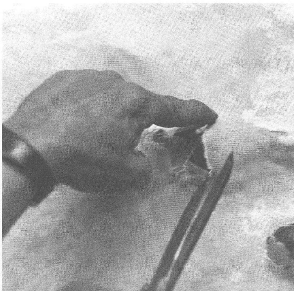
Abb. 6 Lackprofil-Abnahme beim Augster Theater 1988: Mit dem Pinsel getränkt in «Elotex» wird die Jute auf den «Calicot»-Stoff geleimt. Bei Unebenheiten im Profil (Vertiefungen oder vorstehende Steine) wird mit dem Skalpell oder der Schere jeweils ein Kreuzschnitt angelegt und das Gewebe satt an die Ränder der Unebenheit angedrückt.
