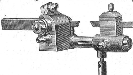
Neuester doppelter Gewindedrehstahlhalter, patentiert in allen Staaten.
