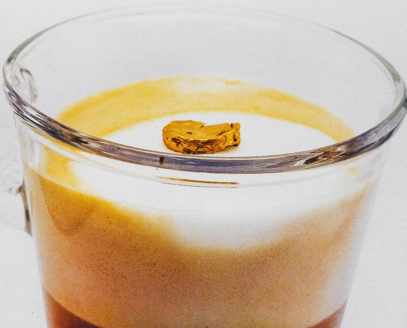
Eine Art Schwamm aus Gold und Protein: Das Aerogel mit wenig Feststoff und grosser Oberfläche könnte einmal ein Katalysator werden. Bild: Nyström/Mezzenga
