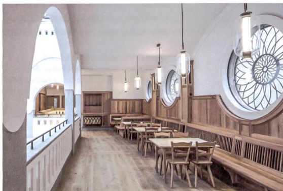
Oben der Rabitzputz, unten das Eichenparkett, Tafelung und Möbel sind aus Birnbaum.
