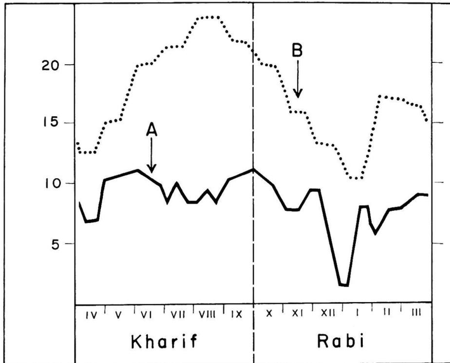
Fig. 3. Wasserbedarf und Wasserverbrauch im Punjab. A Effektiver Wasserverbrauch, B Errechneter Bedarf der Kulturen. Angaben in 1000 cusec (1 cusec = 102 m<sup>3</sup>/h).
