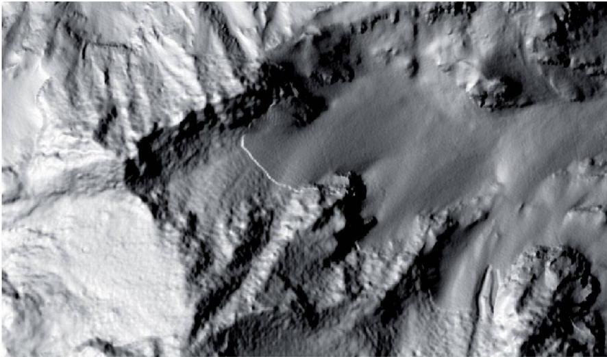
Fig. 9: Exemple de passage entre les données stéréo-corrélées et le MNT-MO (LIDAR) dû à des manteaux neigeux différents lors du vol LIDAR et image.
