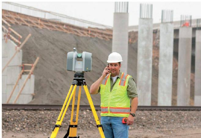
bis zu 120 m. So können mit dem Trimble TX8 präzise 3D-Punktwolken mit hoher Dichte schnell und einfach erzeugt werden. Der Trimble TX8 zeichnet sich durch unerreichte Flexibilität aus, denn die Reichweite der Messungen lässt sich bis auf 340 m vergrössern. Das verringert die Anzahl der beim Scannen vor Ort erforderlichen Standpunkte und die Einsatzmöglichkeiten des Trimble TX8 werden dadurch beträchtlich erweitert.
