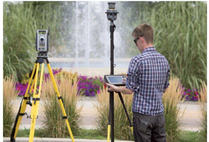
aufweisen (z.B. Industrieanlagen in der Öl- und Gaswirtschaft), sodass sich auch grössere Datenmengen mit geringem Zeitaufwand bewältigen lassen. Die auf dem robusten Trimble Tablet PC installierte Trimble Access Feldsoftware bietet in einfachen und intuitiven Schritten die Möglichkeit, Bilder aufzunehmen und zu überprüfen sowie Messungen zu speichern.
