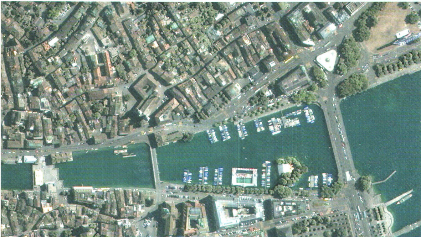
Abb. 1: IKONOS-Aufnahme von Zürich mit Bellevue und Limmat (Echtfarben, 1 m). Quelle: European Space Imaging/MFB-GeoConsulting.
