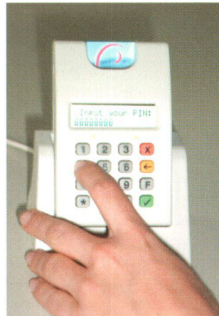
Abb. 1: Für die «digitale Signatur» wird ein Kartenleser an den Rechner angeschlossen, der die persönliche Signatur (Public Key Service Karte) zusammen mit einer PIN auswertet und verifiziert.
