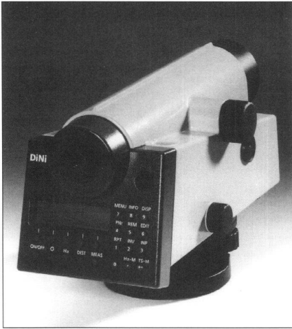
Nivellieren in drei Dimensionen: Total Level Station DiNi 10 T von Carl Zeiss.
