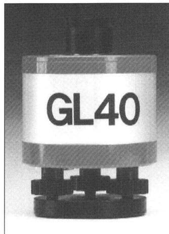
Der kleine Rotationslaser im Ganzmetallgehäuse mit sichtbarem Laserstrahl kann horizontal und vertikal eingesetzt werden. Mit Hilfe der Dreifuss-schrauben werden die genauen Libellen schnell und leicht eingestellt. Die Umdrehung des Rotorkopfes kann stufenlos bis zum Stand reguliert werden. Der integrierte Strahlteilerkopf ermöglicht eine schnelle Absteckung rechter Winkel.
