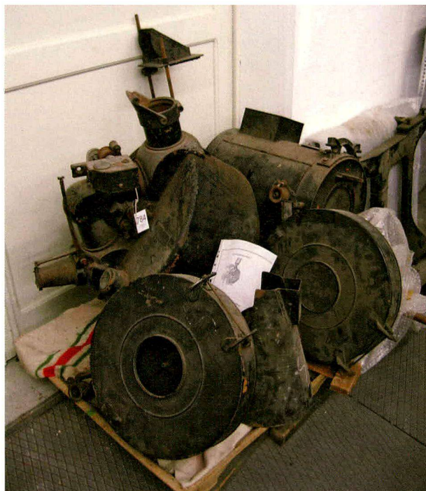
35-mm-Filmprojektor Mechau III der Ernst Leitz Kinowerk GmbH Rastatt, 1923, zerlegt und unrestauriert.
