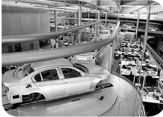
Förderstrecken im Zentralgebäude.
