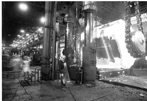
Der Rohblock wurde auf einem grossflächigen Untersattel auf der 8000-Tonnen-Press gereckt (Bildnachweis: privat).
