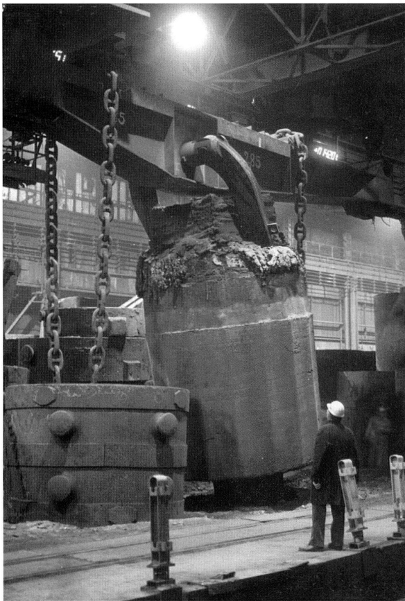
Der Schmiedeblock wird zur Schmiede transportiert (Bildnachweis: privat).
