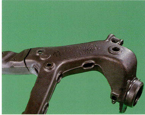
Abb. 2: Fahrwerksteil (MPV-Schräglenker) nach einer Schwingprüfung: Dank «weicher» Übergänge mit grossen Radien erfolgt der Bruch in der Prüfung nicht in der Anbindung des Arms.
